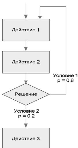
Рис. 6.7. Условное выполнение действий в цикле
