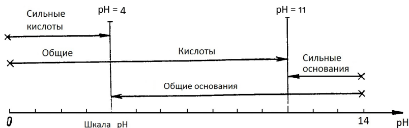
Рис. 4.4. Схема соотношений между кислотными и щелочными уровнями присадок в маслах [2]
