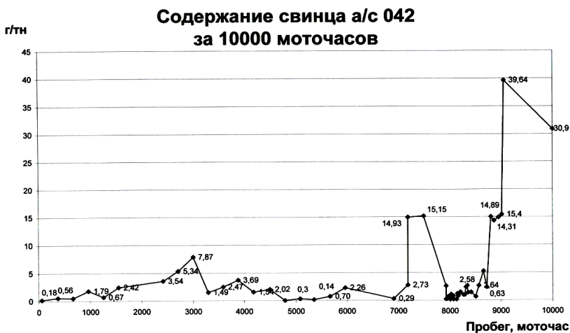
Рис. 5.5. Динамика содержания свинца в моторном масле «Квалитет» CF-4/SG 15W-40 дизеля КТА-38 (Cummins); анализом во ВНИИ НП по методике ГОСТ 20502–75 подтверждена предельная коррозионность масла класса \Gamma_2 - 20 \text{ г/м}^2 ; для масел класса \Gamma_{2K} коррозионность не допускается
