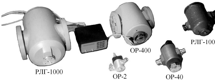
Рис. 3.19. Датчики В. В. Домогацкого расходомеров Московского лесотехнического института (ОР-2, ОР-40, ОР-400, РЛГ-100 и РЛГ-1000) и вторичный прибор МС-75
