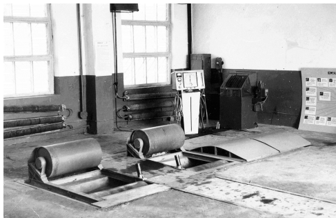
Рис. 3.4. Макетный образец диагностического стенда для колесных тракторов на СТОТ
