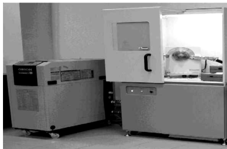
Рис. 6.23. Рентгеновский дифрактометр XRD 6000 фирмы Shimadzu для определения фазового и химического состава порошков
