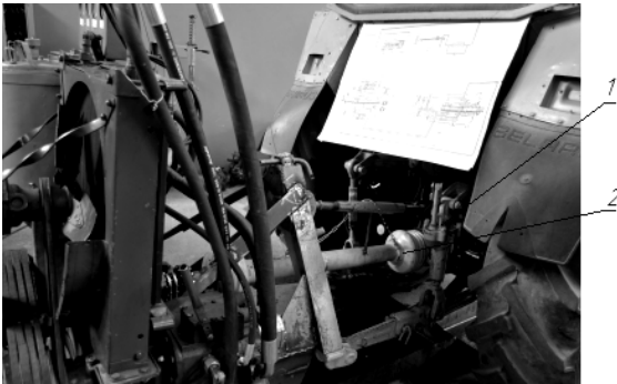
Рис. 3.11. Стенд для испытания двигателей тракторов: 1 – заднее навесное устройство трактора; 2 – карданная передача
