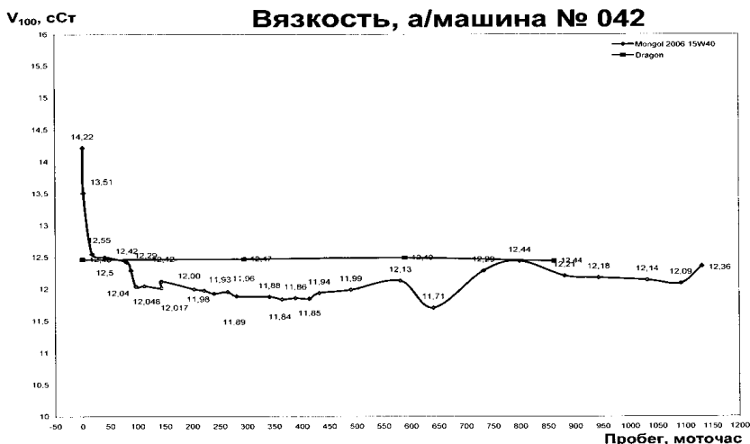
Рис. 4.10. Динамика вязкости масел «Квалитет» (Mongol 2006, CF-4, 15W-40 – нижняя кривая) и масла Dragon (CG-4, класс вязкости 40) за 1200 ч
