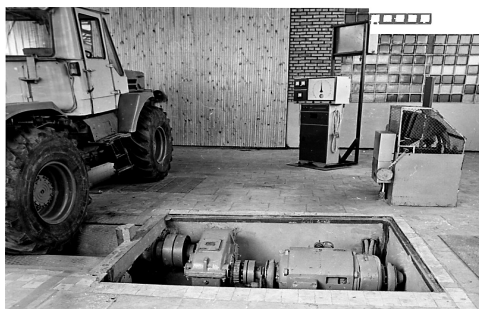
Рис. 3.5. Диагностический стенд для колесных тракторов КИ-8927-ГОСНИТИ (привод открыт для демонстрации устройства стенда)
