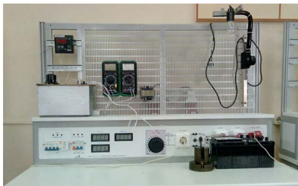
Рисунок 1. А) Внешний вид базового стенда НТЦ-08.47.1 "Электромонтажный комплекс". Б) доработанный стенд для выполнения работы «Электрические свойства проводниковых и полупроводниковых материалов»
