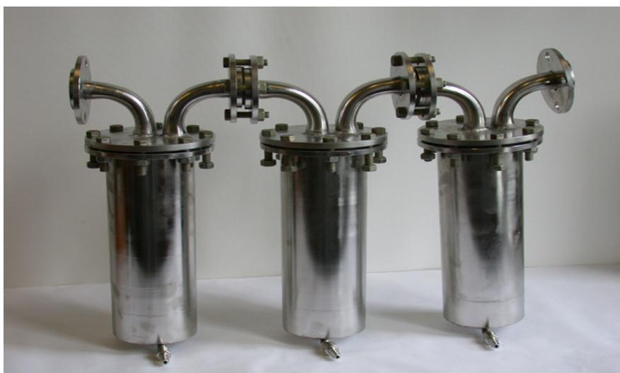
Рисунок 1 – Внешний вид устройства для стерилизации воздуха производительностью 5 м<sup>3</sup>/ч
