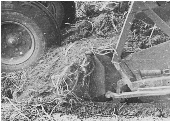
Рис. 1. Сгуживание подкапанного пласта картофельной грядки на рабочих органах приемной части картофелеборочной машины
