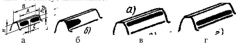
Рисунок 3.3.2.7 Расположение пятен контакта при качественной (а) и некачественной (б–г) сборке цилиндрической передачи.
