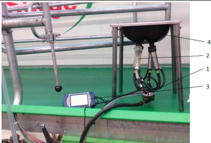
1 – доильный аппарат; 2 – экспериментальный доильный стакан; 3 – тестер VPR-100; 4 – искусственная вымя
