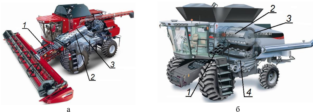
Рисунок. 1– Зерноуборочные комбайны с роторной молотильной системой: а – расположенной по направлению движения; б – перпендикулярно направлению; 1 – наклонная камера; 2 – ротор; 3 – кожух; 4 – воздушно-решетчатая очистка
