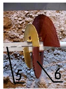
Рисунок 1 – Лабораторный образец роторного гребнеобразователя:
