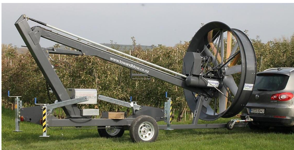
Рисунок 1 – Установка для перемешивания воздуха в саду, фирмы «Tow and blow», Финляндия
