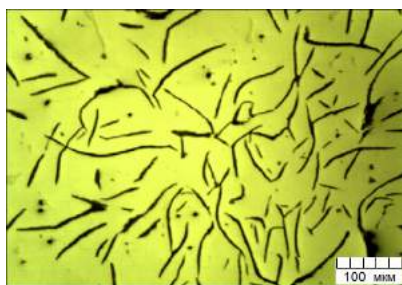
Рис. 2.7. Графит в сером чугуне: шаровидный графит (а), пластинчатый графит (б)
