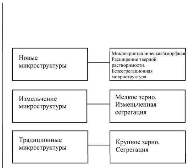
Рис. 2.2. Влияние скорости охлаждения при кристаллизации на тип формирующейся литой микроструктуры
