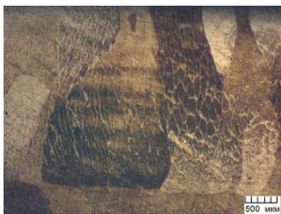
Рис. 2.14. Алюминий А7 литой: зона транскристаллизации ( a ), дендритная структура внутри зерна ( б )
