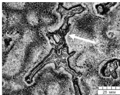
Рис. 2.35. Микроструктура БрОФ10-1: дендритная структура ( a ), эвтектоид и фосфид меди ( б )
