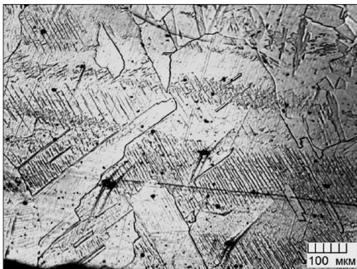
Рис. 5.6. Микроструктура аустенитной марганцевистой стали Г13 после закалки в воду с 1100 °С: аустенит с двойниками
