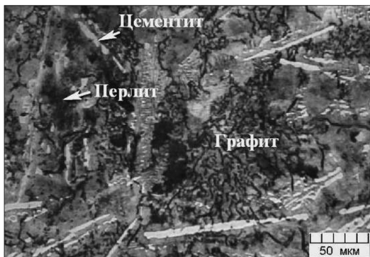
Рис. 3.7. Микроструктура половинчатого чугуна после травления: вермикулярный графит, перлит и цементит – белые пластины
