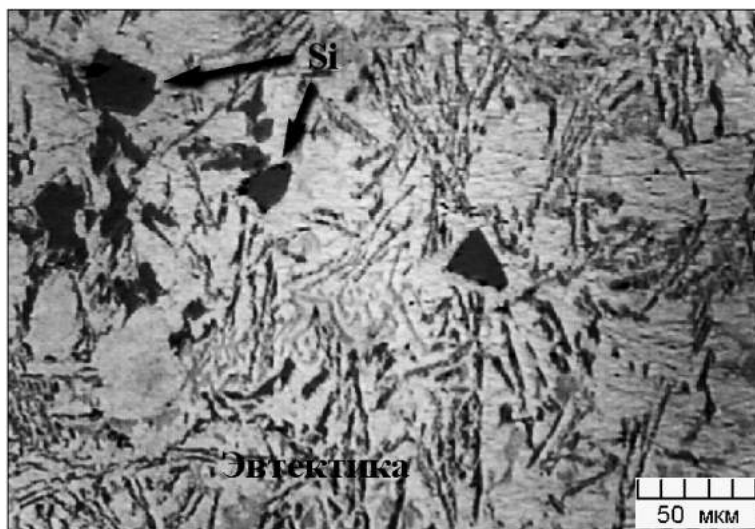
Рис. 8.3. Микроструктура литого силумина АК12: грубая игольчатая эвтектика Al+Si с отдельными кристаллами избыточного кремния
