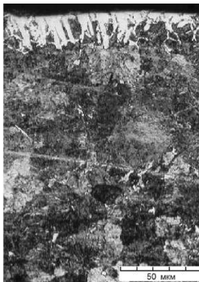
Рис. 6.11. Структура борированных слоев в сталях 25ХГТ ( a ), 45 ( б ), 40Х ( в )
