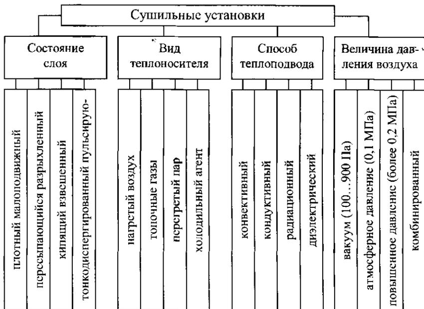
Рис. 17.1 Классификация сушильных установок
