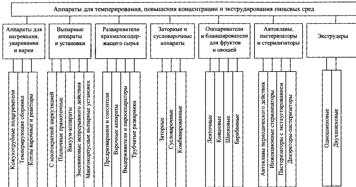
Рис. 16.1 Классификация аппаратов для темперирования, повышения концентрации и экструдирования пищевых сред
