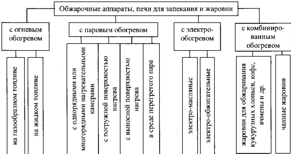
Рис. 18.3 Классификация обжарочных аппаратов, печей для запекания и жаровен
