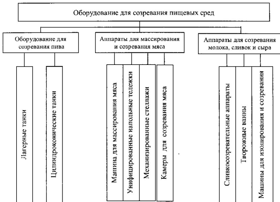
Рис. 26.2 Классификация оборудования для созревания пищевых сред
