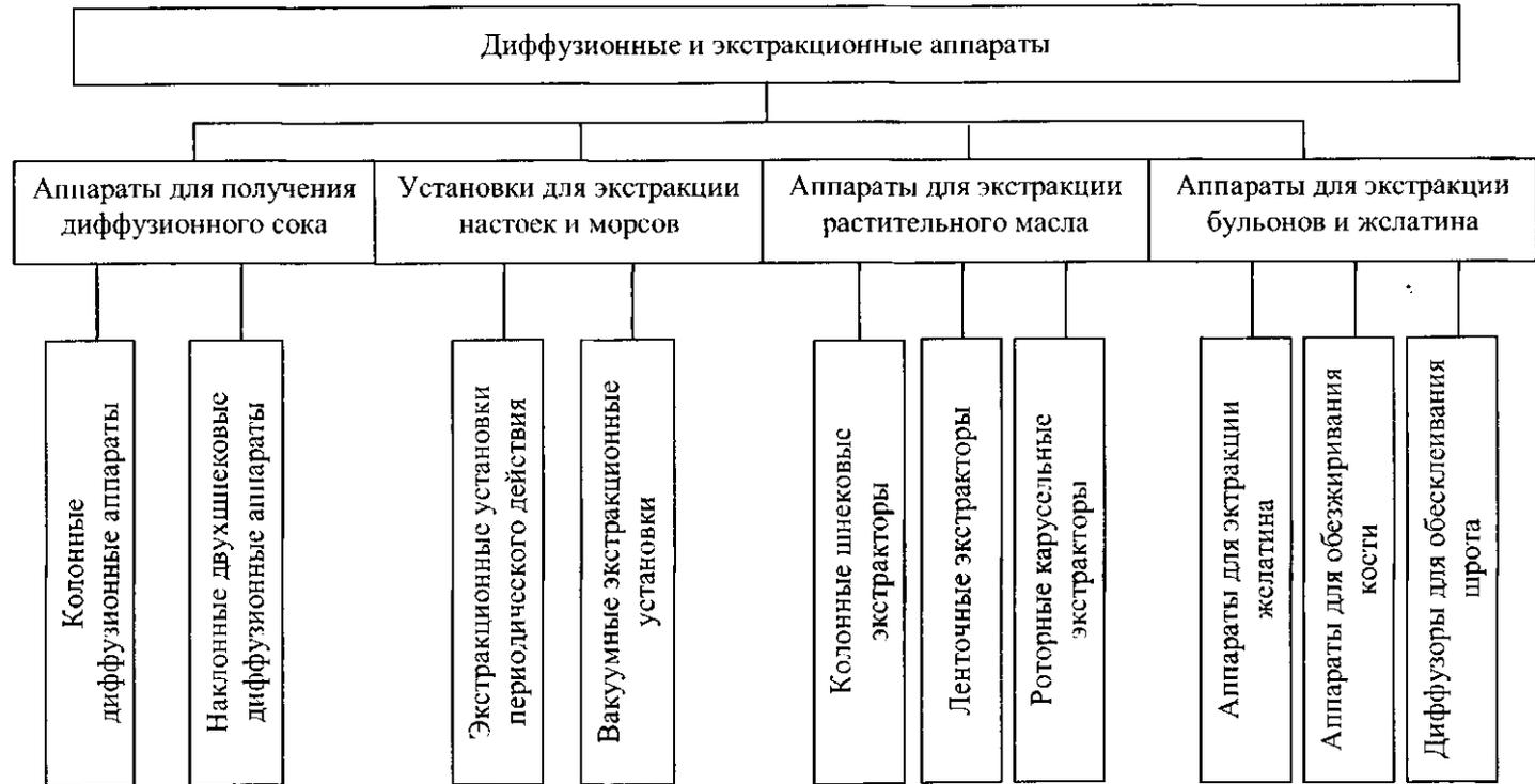
Рис. 20.1 Классификация диффузионных и экстракционных аппаратов
