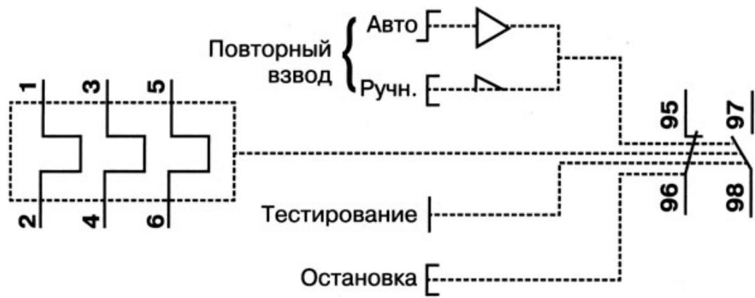
Рисунок 1.25 – Электрическая схема РТИ
