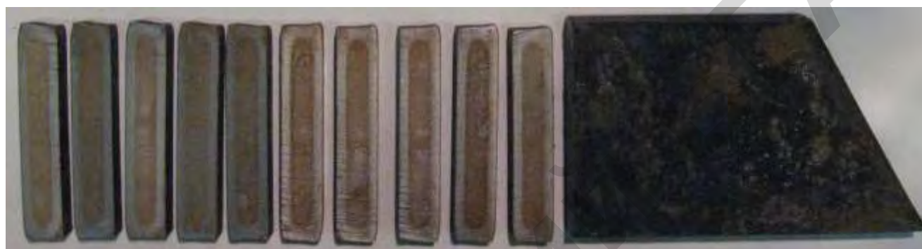
Рисунок 1. Макрошлиф поперечного сечения пластины толщиной 12 мм
