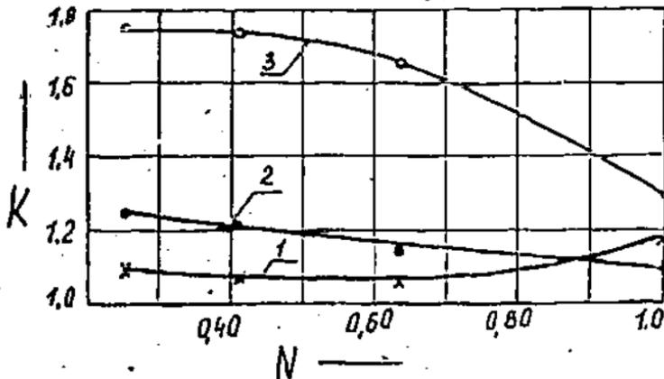
Рис. 3. Уменьшение неравномерности глубины хода высевающего сошника разами обусловленного коэффициентом  $K$ , в зависимости от коэффициента  $N$  соприкосновения с почвой рабочих органов окончательной подготовки почвы: 1-супель; 2-тяжелый суглинок; 3-легкий суглинок.
