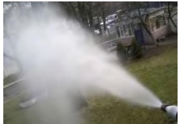
Рисунок 3. Форма струи с максимальным углом распыления ( $d_n = 1,8\text{мм}$ ,  $p \geq 12\text{МПа}$ )
