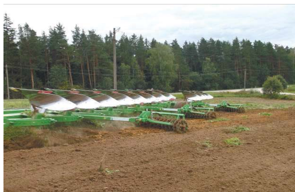
Рис. 8. Плуг ПО-(8+4)-40 с приставками в процессе работы
