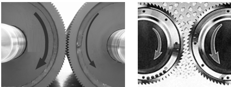
Рис. 1.17. Плющильный аппарат с рельефом поверхности валцов в виде зубцов
