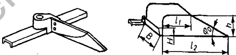
Рис. 9.4. Расчетная схема тела волочения связного груза (перед скребком)
