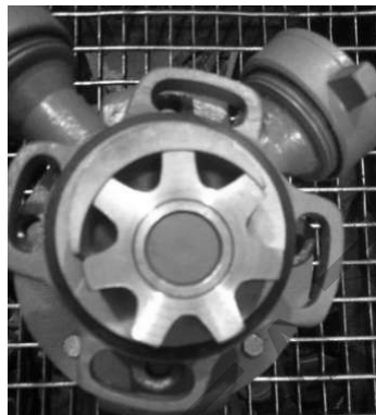
Рис. 10.37. Роторный зубчатый насос с внутренним зацеплением: 1 – зубчатое колесо; 2 – зубчатый диск; 3 – серповидный вкладыш; 4 – корпус насоса; 5 – всасывающий патрубок; 6 – нагнетательный патрубок
