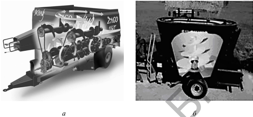
Рис. 6.9. Измельчители-смесители-раздатчики кормов а – с горизонтальным расположением шнеков; б – с вертикальным расположением шнеков
