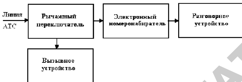
Рисунок 7.8 - Структурная схема электронного ТА (с кнопочным номеронабирателем)
