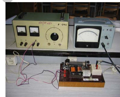
Рисунок 17 — Принципиальная схема и общий вид лабораторной установки: \mathcal{E} — регулируемый источник переменного тока; V_1, V_2 — вольтметры; R — резистор, Tr — замкнутый сердечник из исследуемого ферромагнетика с намагничивающей и измерительной обмотками
