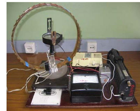
Рисунок 10 — Принципиальная схема и общий вид лабораторной установки: \mathcal{E} — источник питания, mA — миллиамперметр, K — переключатель направления тока в витках, ТГ — витки тангенс-гальванометра, ПМ — перемычка для выбора количества витков, R — реостат
