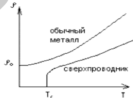
Рисунок 21 — Зависимость удельного сопротивления \rho от абсолютной температуры T при низких температурах
