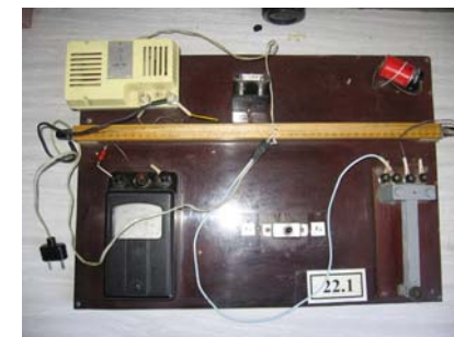
Рисунок 16 — Принципиальная схема и общий вид лабораторной установки. \mathcal{E}_0 — элемент Вестона, \mathcal{E}_x — исследуемый элемент, \mathcal{E} — источник постоянного тока, \Gamma — нульгальванометр, K_1 — ключ, К — двойной ключ, ab — реохорд
