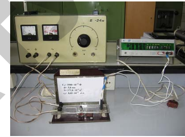
Рисунок 8 — Принципиальная схема и общий вид лабораторной установки: C_0 — конденсатор с известной емкостью, C_B — плоский воздушный конденсатор с неизвестной емкостью, C_d — тот же конденсатор с плоской пластиной из диэлектрика, K — переключатель, V — вольтметр
