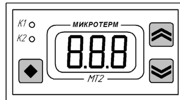
Рисунок 13.2 – Общий вид лицевой панели прибора
