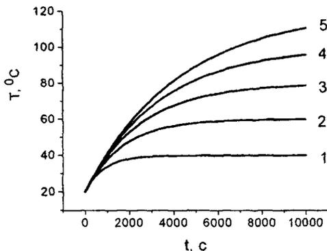
**Рисунок 1** – Изменение температуры слоя воды толщиной  $10^{-3}$  м при поглощении мощности  $100 \text{ Вт/м}^2$  и значениях толщины изолирующего слоя  $d$ , м: 0.01 (1), 0.02 (2), 0.03 (3), 0.04 (4), 0.05 (5) и его теплопроводности  $0,05 \text{ Вт/м К}$ .
