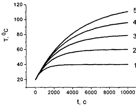
**Рисунок 1 – Изменение температуры слоя воды толщиной  $10^{-3}$  м при поглощении мощности  $100 \text{ Вт}/\text{м}^2$  и значениях толщины изолирующего слоя  $d$ , м: 0.01 (1), 0.02 (2), 0.03 (3), 0.04 (4), 0.05 (5) и его теплопроводности  $0,05 \text{ Вт}/\text{м К}$ .**
