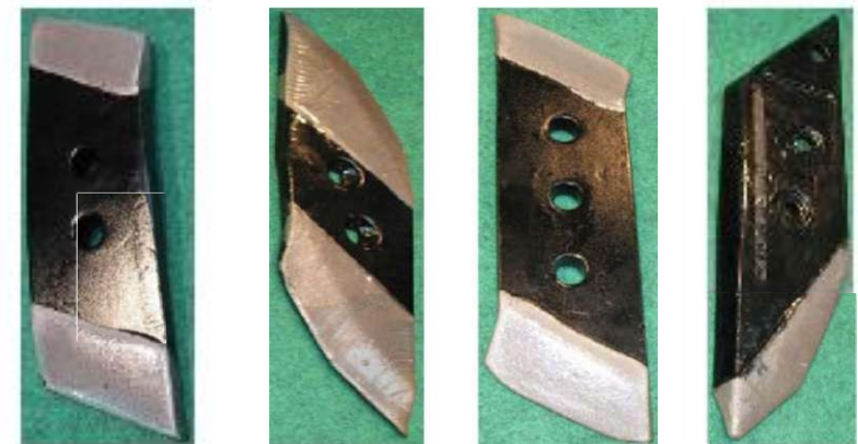
Рис. 3.6. Образцы долот с почворезущими профилями, упрочненными твердосплавными покрытиями
