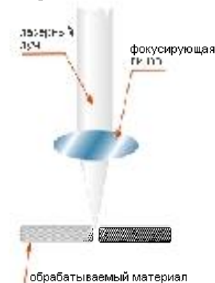
Рис. 5.8. Фокусировка лазерного луча на месте реза
