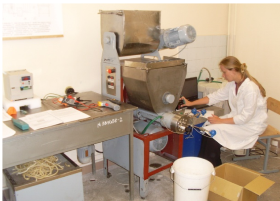
Рисунок 4. Проведение экспериментальных исследований на малом макаронном прессе МИТ-2
