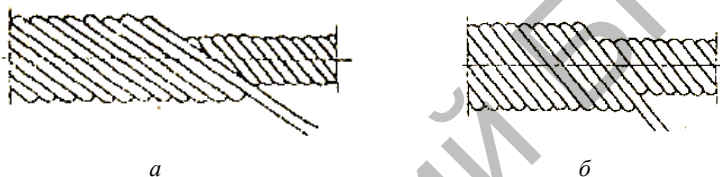
Рис. 21.4. Пряди канатов с точечным (а) и линейным (б) касанием проволок
