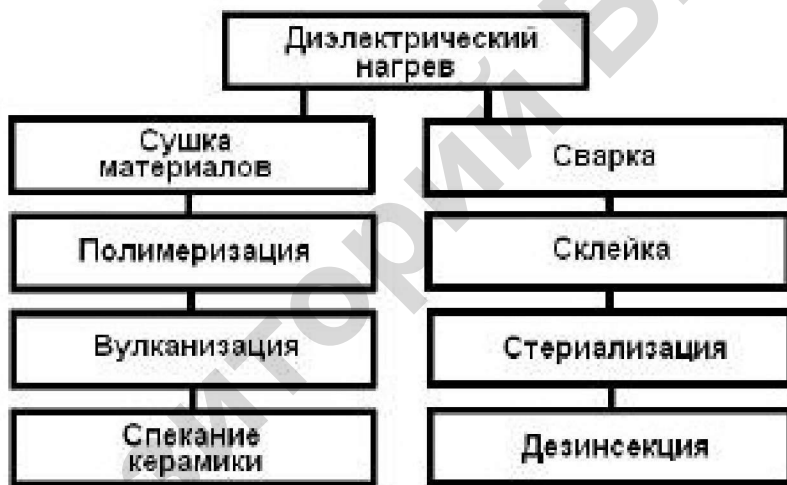
Рис. 7.2. Классификация технологии диэлектрического нагрева
