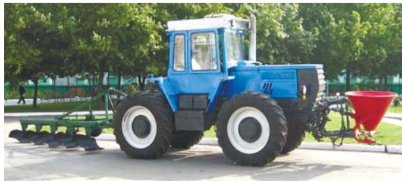
Рисунок 2. Комбинированный МТА на основе трактора серии ХТЗ-160
