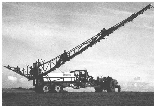
*Рис. 4.1.* Опрыскиватель фирмы EVRARD с емкостью 5500 л и шириной захвата 36 м
