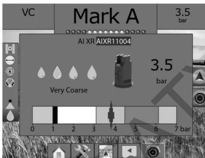
*Рис. 1.17.* Пример работы функции «Монитор размера капель». Данные навигатор получает от установленного в опрыскивателе датчика давления на шине CAN
