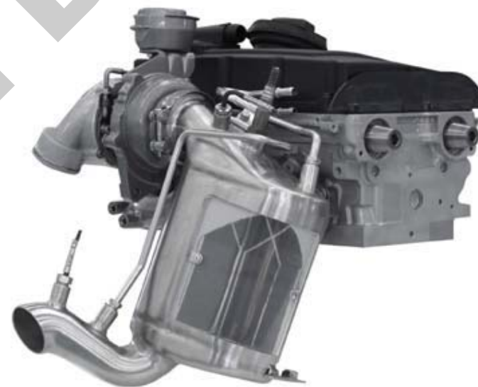
Рис. 2.19. Внешний вид и размещение сажевого фильтра на автомобилях Volkswagen:
