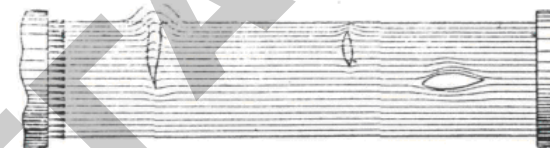
Рисунок 2. – Искажения магнитного потока несплошностями в детали
