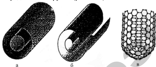
Рис. 6.12. Модели поперечного сечения многослойных нанотрубок: а — «русская матрешка»; б — свисток; в — атомарная структура закрытой с торца однослойной нанотрубки
