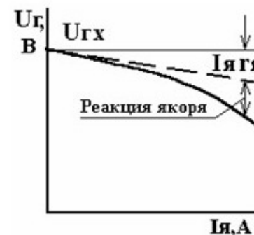
Рис. 1.4. Внешняя характеристика генератора с независимым возбуждением
