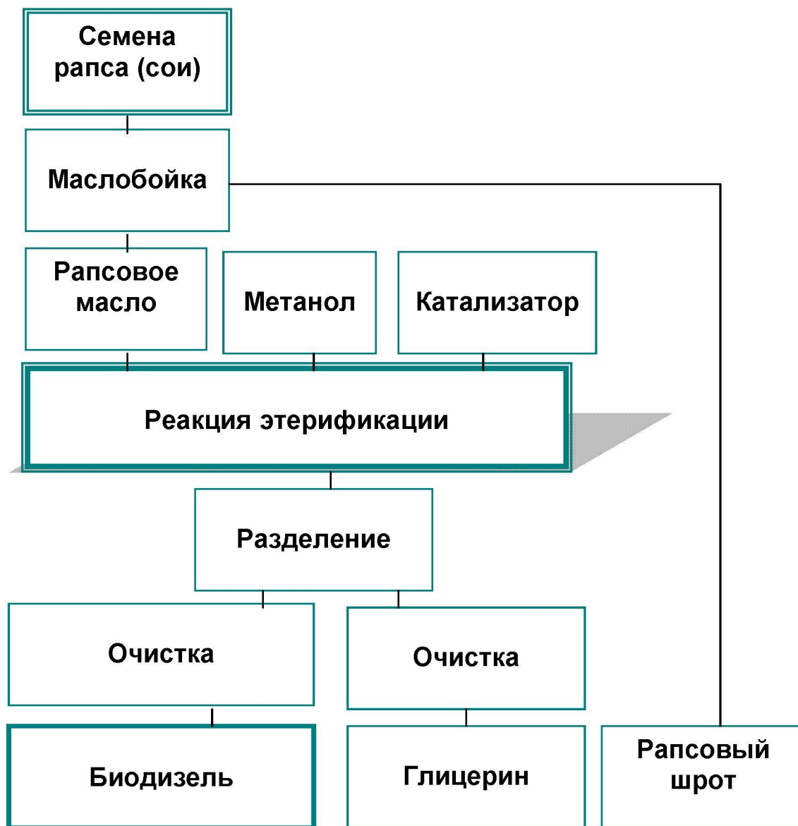
Рис. 18. Процесс получения биодизеля и побочного глицерина из рапса
