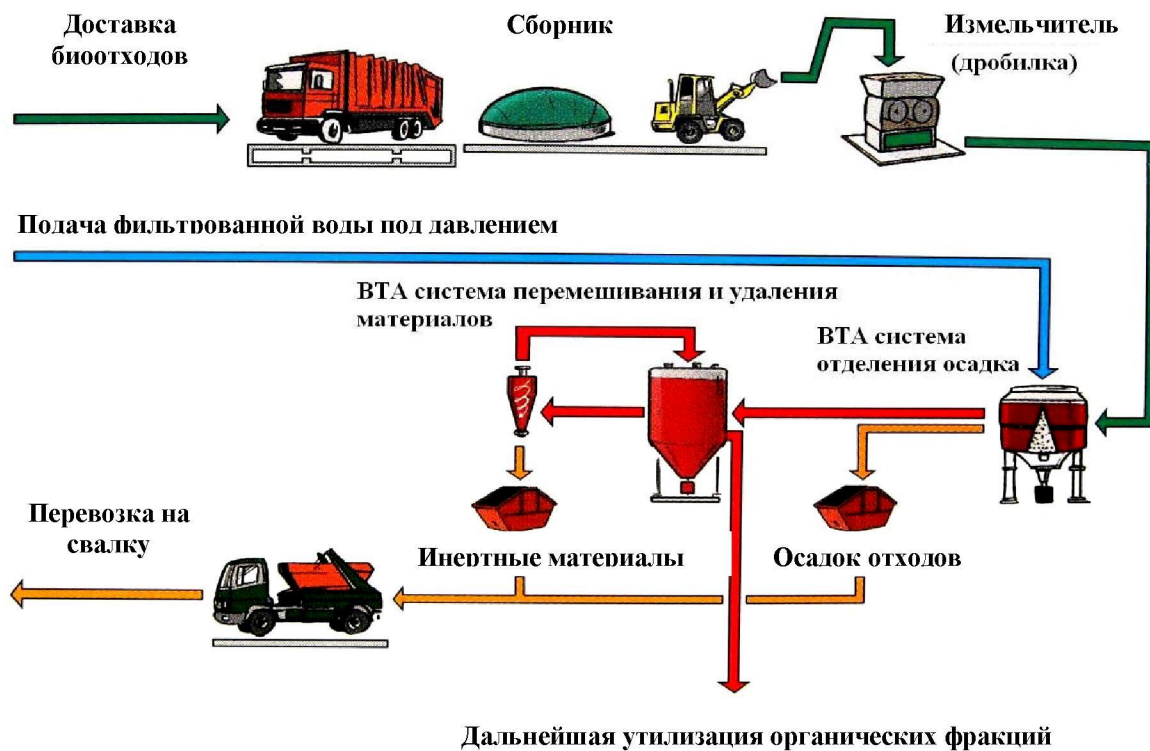
Рис. 52. Гидромеханическая система переработки отходов
