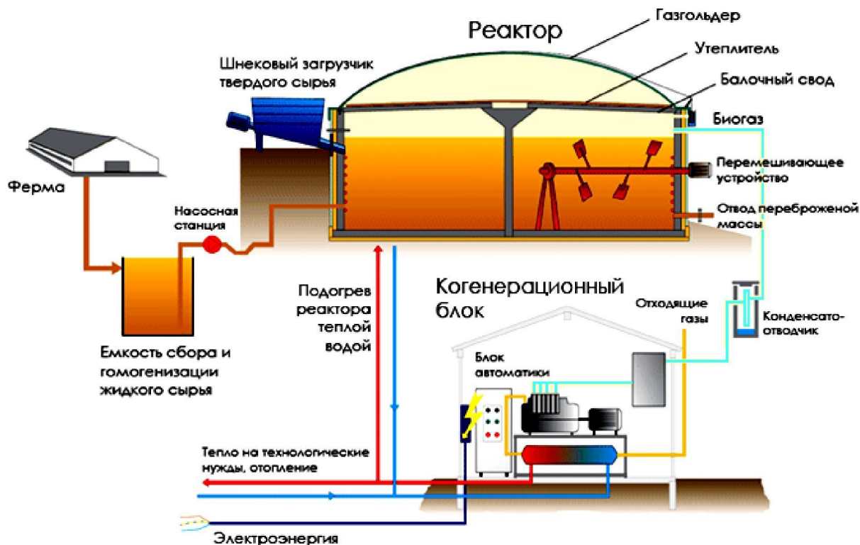
Рис. 24. Принципиальная схема биогазовой установки
