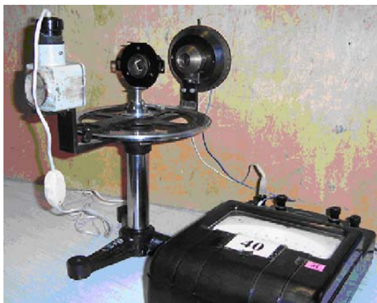
Рис. 1.22. Лабораторная установка для получения и анализа плоско-поляризованного света
