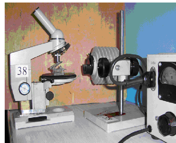
Рис. 1.4. Общий вид лабораторной установки для наблюдения колец Ньютона в отраженном свете
