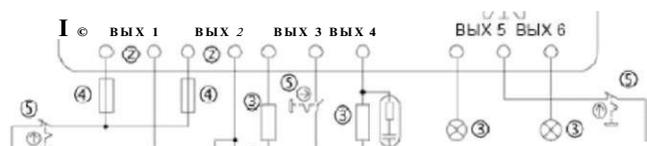
Рис. П. 3.9. Схема электрических соединений выходных реле главного блока (переменный ток и/или постоянный ток):
