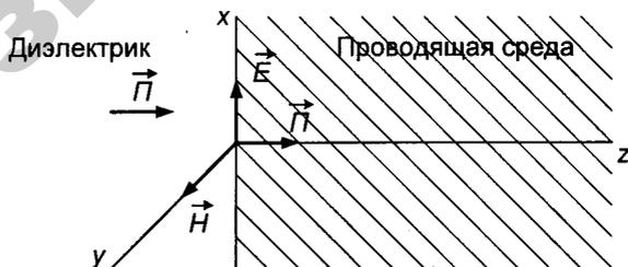
Рисунок 8.34 — Граница между диэлектриком и проводящей средой
