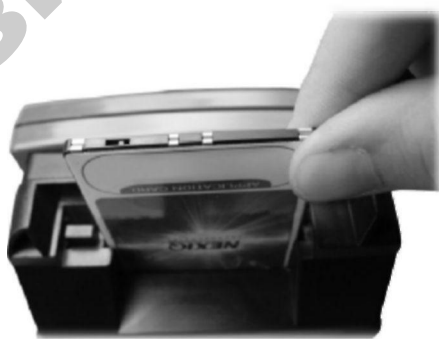
Рис. 2.35. Установка электронной карточки для многопротокольного картриджа
