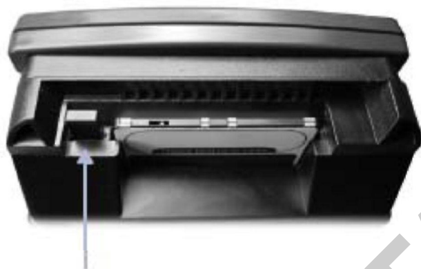
Рис. 2.36. Извлечение электронной карточки для многопротокольного картриджа
