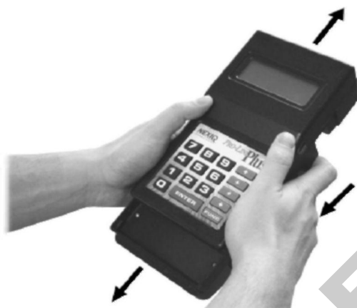
Рис. 2.34. Разборка корпуса диагностического прибора Pro-Link 9000 с картриджем
