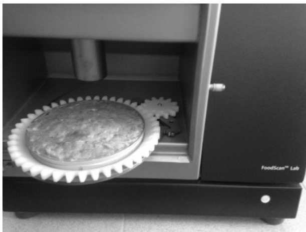
Рисунок 2 – Исследования на химическом анализаторе мяса и мясных продуктов «ФудСкан»
