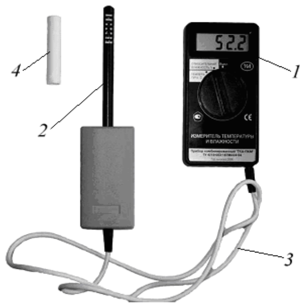
Рис. 1.3. Внешний вид прибора ТКА-ПКМ/20: 1 – блок обработки сигналов; 2 – измерительная головка; 3 – кабель связи; 4 – защитный колпачок
