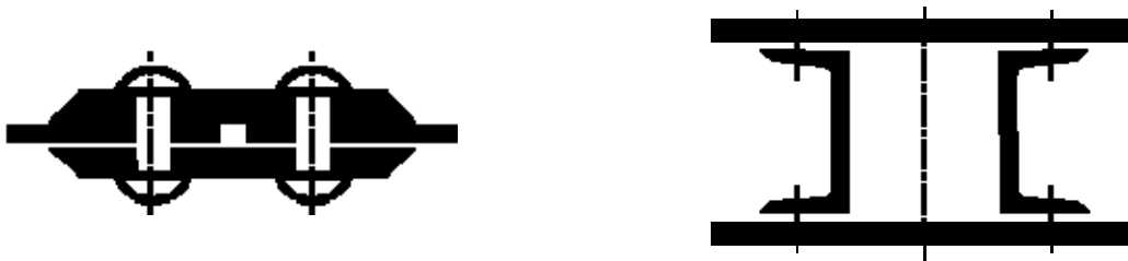
Рис. 1.14. Штриховка узких площадей, ширина которых на чертеже менее 2 мм
