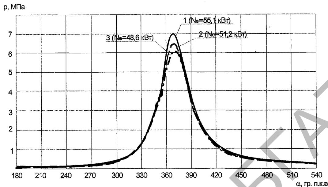
Рис. 2 Индикаторные диаграммы дизеля при работе на:
