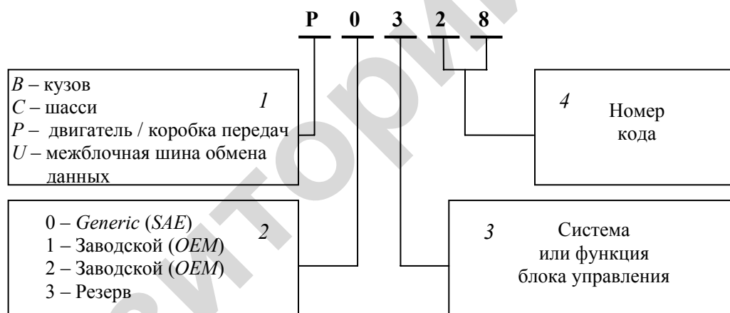
Рис. 2.8. Расшифровка системы обозначений ДКН по протоколам OBD-II и OEM
