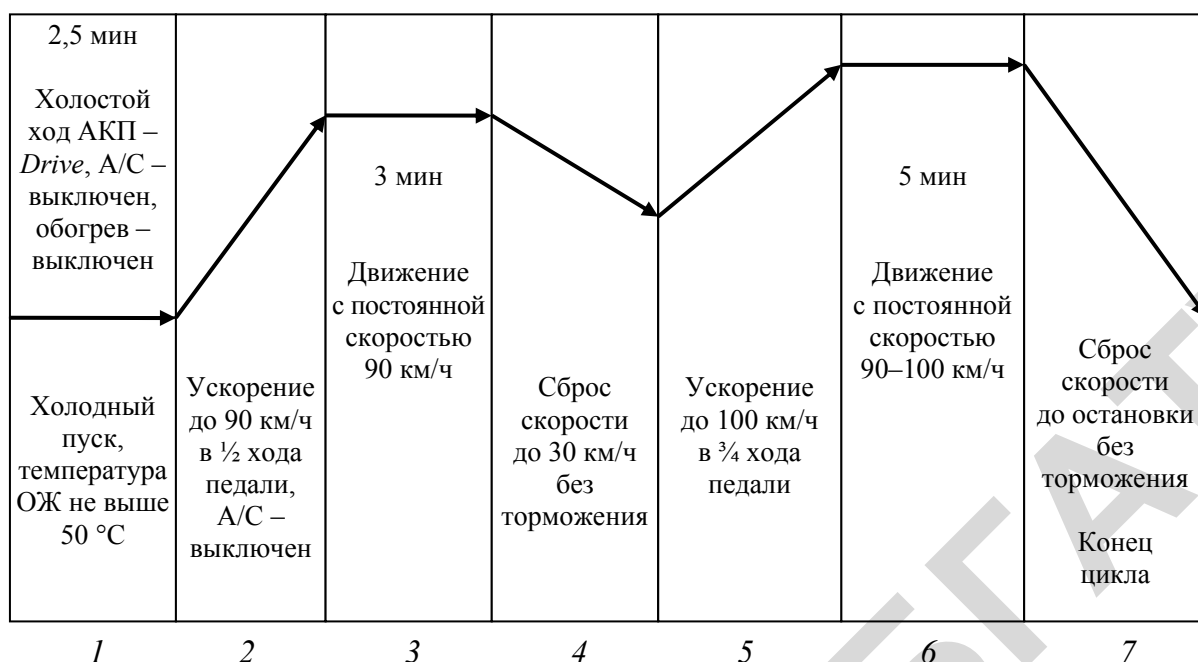
Рис. 2.10. Диаграмма ездового цикла и активируемые компоненты: 1 – подогрева \lambda -зонда, пропусков воспламенения смеси, массового расхода топлива; 2 – пропусков воспламенения смеси; 3 – пропусков воспламенения смеси, рециркуляции отработавших газов, массового расхода топлива, подогрева \lambda -зонда; 4 – рециркуляции отработавших газов; 5 – пропусков воспламенения смеси; 6 – катализатора, пропусков воспламенения смеси; 7 – рециркуляции отработавших газов; АКП – автоматическая коробка передач
