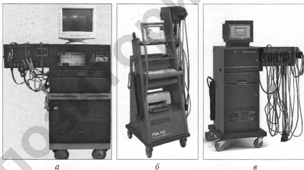
Рис. 1.11. Моторы-тестеры различных производителей: а – «Автомастер АМ-1» (РФ); б – FSA740 фирмы BOSCH (Германия); в – FSA560 фирмы BOSCH (Германия)
