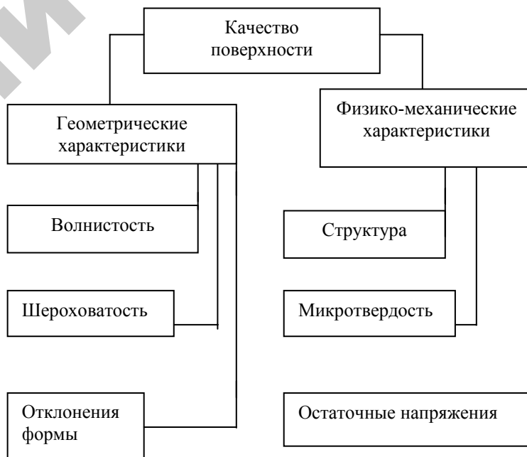
Рис. 1.18. Основные свойства обработанной поверхности
