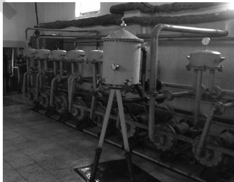
Рисунок 3. Экспериментальный образец испытаний гидроциклонной установки.
