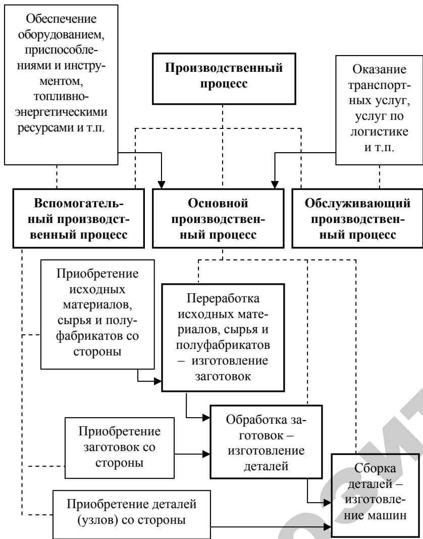
Рис. 1.2. Структурная схема производственного процесса на машиностроительном предприятии
