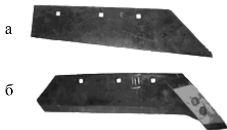
Рис. 4.54. Трапецеидальный лемех (а) и лемех с накладным долотом (б)
