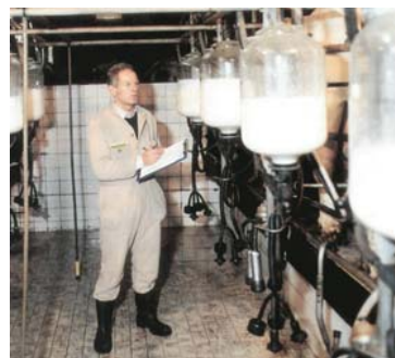
Рисунок 1.23 – Емкостный счетчик учета молока при доении в зале
