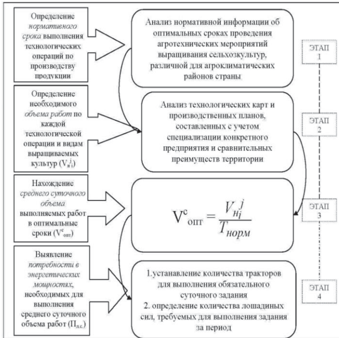
Рис. 1. Алгоритм методики оценки потребности сельхозорганизаций в технике с учетом специфики природных условий
