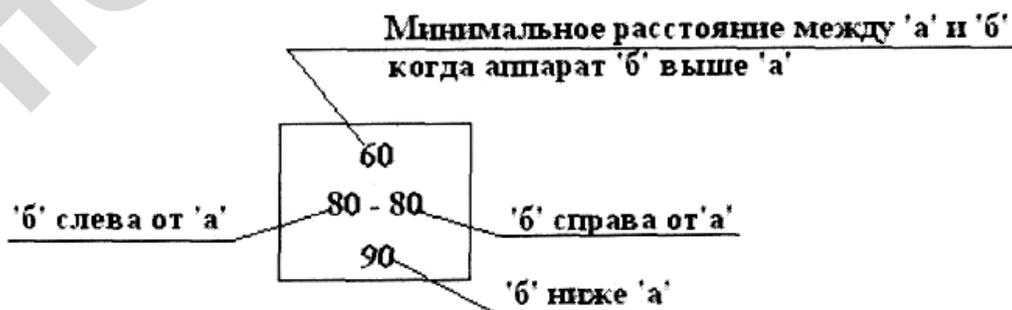
Рис. 7.2. Пример схемы размещения аппаратов по табл. 7.2
