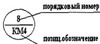
Порядковые номера приборов являются адресами проводников, соединяющими элементы по принципиальной схеме устройства. При этом адрес для аппаратов – только цифры порядкового номера, а для ряда зажимов – номер ряда зажима и через знак «:» порядковый номер конкретного зажима, к которому присоединяется провод. Адрес записывают в торце провода, отходящего от элемента аппарата, а номер проводника (так называемая генеральная маркировка) записывают над проводом или возле зажима для клеммника.
